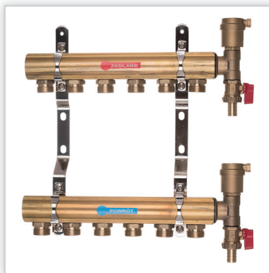
K4R Rozdzielacz mosiężny do c.o. 1'' z nyplami oraz sekcją odpowietrznikowo-spustową.
