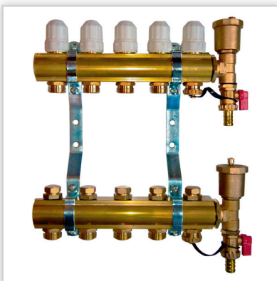
Rozdzielacz CD 468 Rozdzielacz mosiężny do ogrzewania podłogowego 1'' z wkładkami zaworowymi M30 x 1,5 i zaworami odcinającymi oraz sekcją odpowietrznikowo-spustową.
